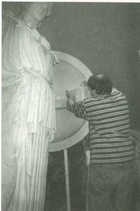
Fig. 7. Formen holdes sammen af et større kappestykke af gips og hessian. Gipsstykkerne inden under er forinden smurt med fortyndet stearin.
