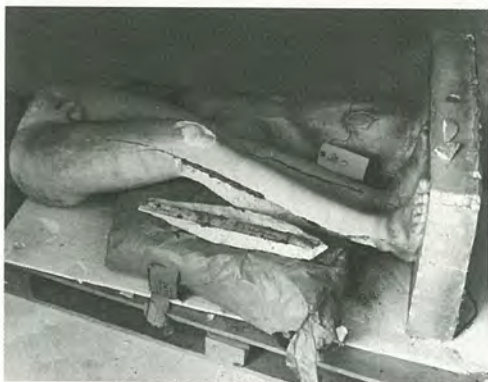
Fig. 14. Underdelen af Adonis fra Centocelle (tidlig 4. årh. f.Kr.). Armeringsjern har sprængt benene på langs.
