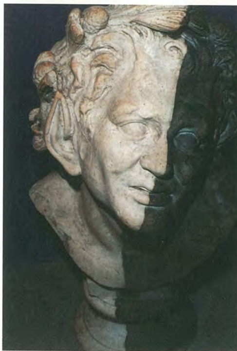
Fig. 2 Laserafrensning af en antik satyr-buste i Bertel Thorvaldsens Afstøbningssamling på Thorvaldsens Museum. Rensningen er halvt færdig.
